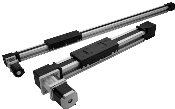
安装时，将电机插入接口法兰，连接并紧固电机螺栓，然后将联轴器紧固至电机轴。最后，用柱塞封住联轴器的访问窗口。
